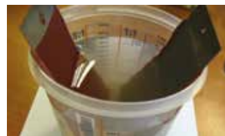
Помещаем пластины в 5%-ый раствор NaCl. Не забываем регулярно контролировать состояние покрытий.
