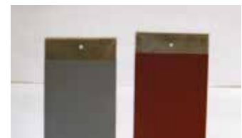
Подготовим для теста одинаковые пластины: QDP — серого цвета, GF-021 — красного.
