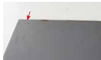
Первые признаки разрушения покрытия QDP обнаруживаются только через 21 день!
