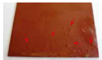
Пластина, обработанная ГФ-021, через 7 дней эксперимента. Хорошо видно, что покрытие разрушается.
