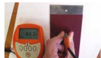
Толщина «сухого» слоя грунта на обеих пластинах одинакова — около 50 мкм.
